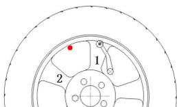
3. На табло высветится “SPO.--2”, после чего выдвиньте измеритель, подведите его к ободу колеса и установите наконечник возле спицы. Остановите колесо и измеритель, после чего система запомнит
