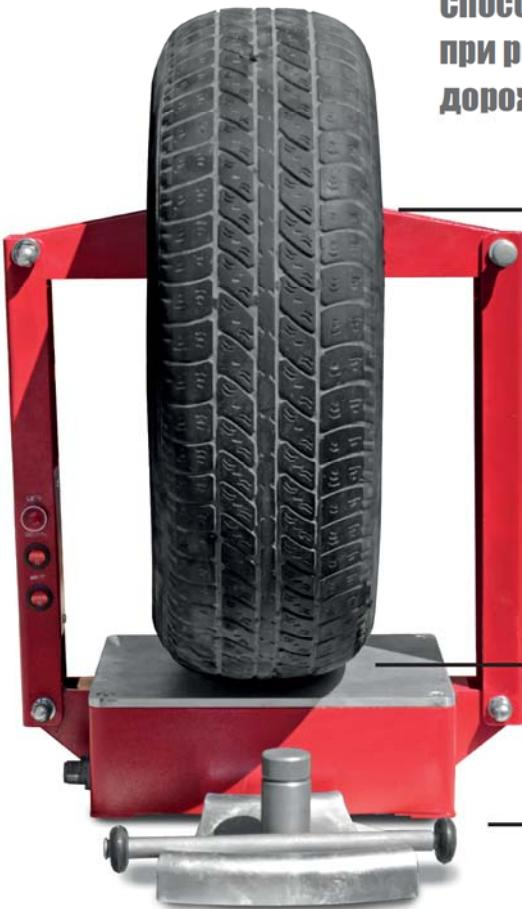
Перед установкой шины необходимо снять вороток с вулканизатора.
