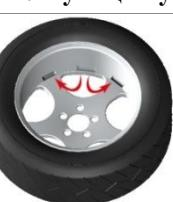
Эта функция позволяет разделить груз установленный между спицами на два груза и спрятать из за соседними спицами.
